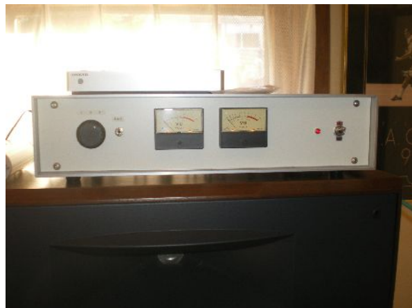
CD用のD/Aコンバータ(上)と金田式アンプ(下) 金田式アンプは電流帰還によるNF方式
